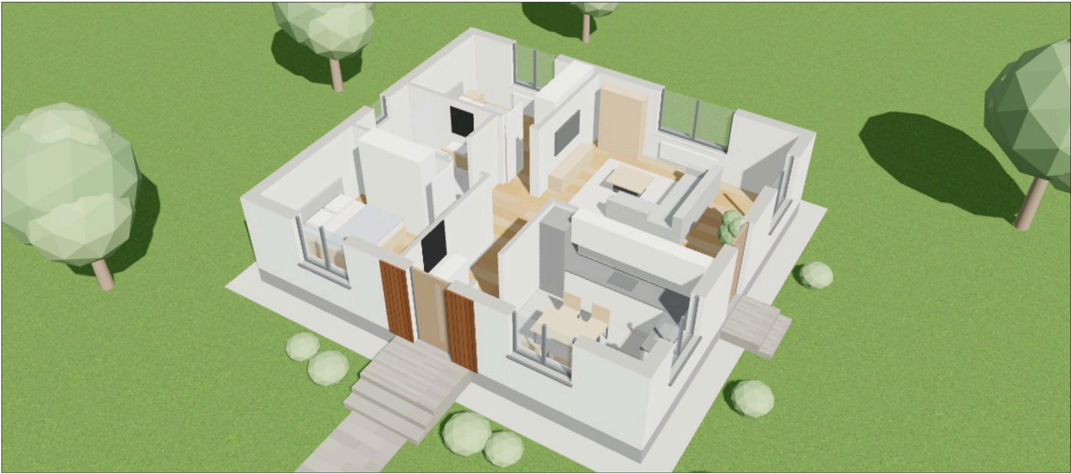
Аксонометрия помещений (стены срезаны на отм. +2,100)
